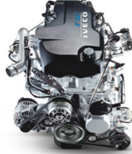
3,0 litrelik F1C Sıkıştırılmış Doğal Gaz motoru
